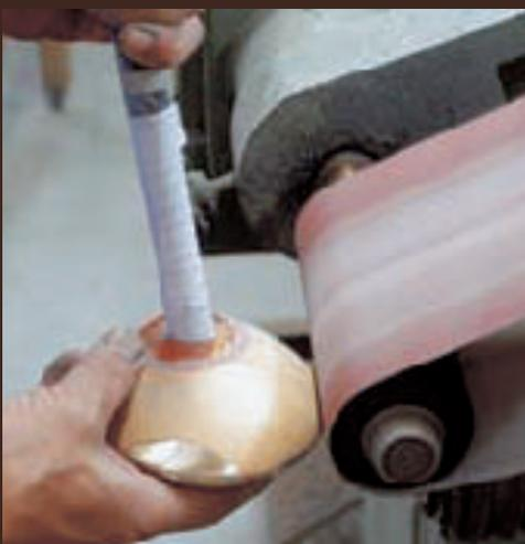
組立て完了後、塗装をはがしながらヘッド形状を整えます。(シャフト差込口付近の塗装は別の機械で綺麗にはがします)
