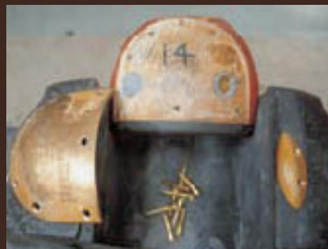
ソールプレート、サイドメタルを取り外し、部品や内部の状態を確認します。
