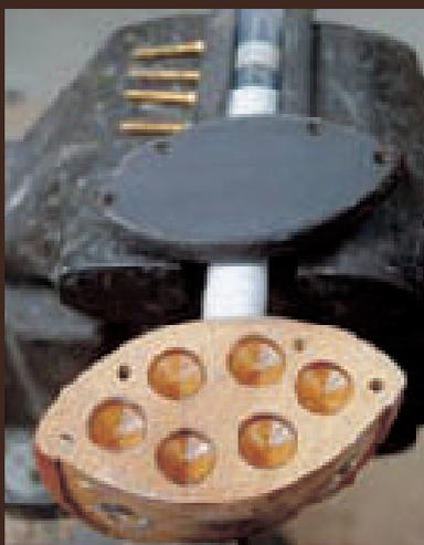
フェースカーボン(打球面)の交換が必要と判断した場合はフェースも取り外します。この後交換が必要な部品を交換し、重量調整(この時グリップも交換)し、各部のゆがみ等を修正
