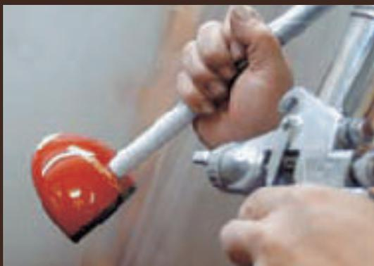
クラブの型番(転写マーク)を貼り付け、仕上げのクリア塗装を行います。(数回塗り乾燥、磨きを繰り返します)
