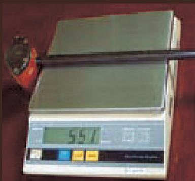
お客様からお預かりしたクラブの重量、長さ、シャフトのゆるみ、各部のスキマ、ガタ、部品の磨耗等を検査します。
