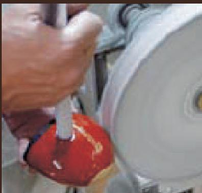
塗装が仕上がったクラブをバフ掛けによって仕上げます。艶が出て輝きます。
