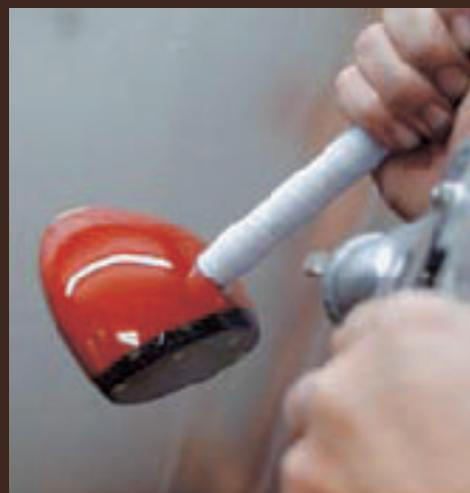
成形が完了したヘッドに下地塗装、色付け等で、中1~2日置きながら数回塗り乾燥、磨きを繰り返します。(実際にはマスキングして塗装しています)
